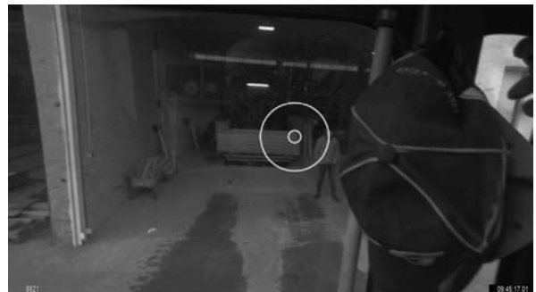
Abbildung 3: Sicht aus Stapler bei Rückwärtsfahrt, Mitarbeiter zu sehen; kleiner Kreis = fovealer Bereich (2 Grad), großer Kreis = parafovealer Bereich (10 Grad).
