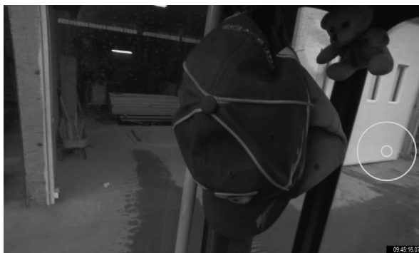
Abbildung 2: Sicht aus Stapler bei Rückwärtsfahrt, Mitarbeiter verdeckt; kleiner Kreis = fovealer Bereich (2 Grad), großer Kreis = parafovealer Bereich (10 Grad).
